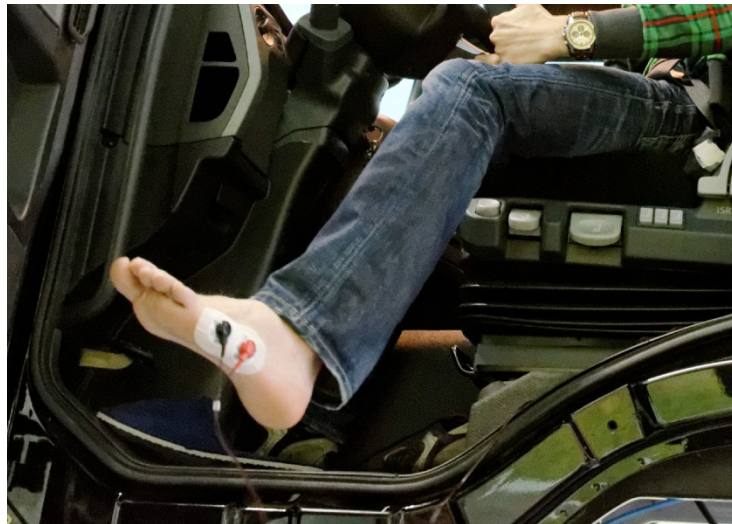
Abbildung 7.12: Anbringung der Elektroden zur Hautleitwertmessung im Fahrsimulatorversuch
