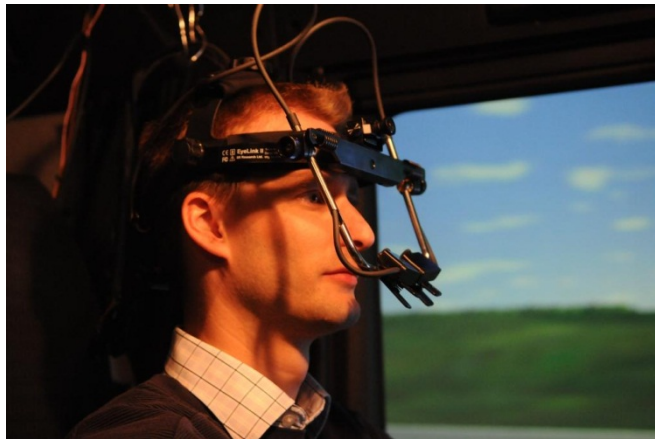
Abbildung 7.11: Versuchsperson mit dem Pupillometrie-Messsystem zur Erfassung des Index of Cognitive Activity
