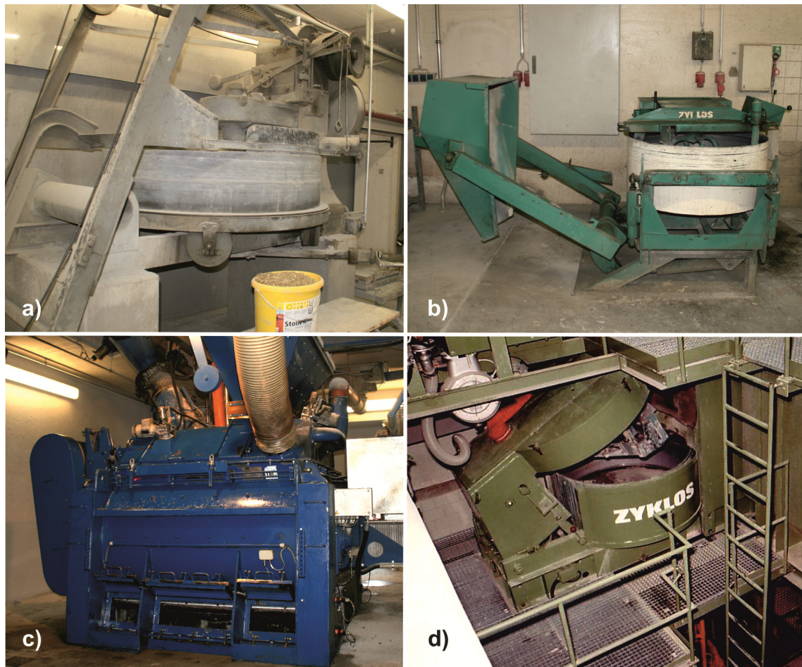
Bild 2.1: Verwendete Betonmischer: a) Eirich KA 44, b) Zyklus ZK 200, c) BHS Sonthofen DKX 6, d) Zyklus ZB 250
