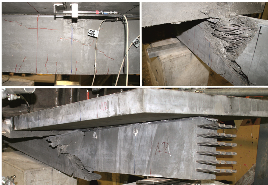
Bild 7.47: Bruchbilder des Plattenbalkens B3 – Rissbild im Bereich der rechten Stoßfuge (links oben), ausgeknickte Litzen (rechts oben) und aufgerissener Steg (unten)
