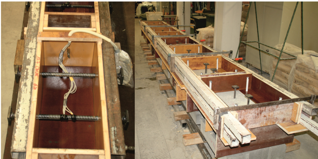
Bild 5.14: Herstellung der Verbundversuchskörper Typ III
