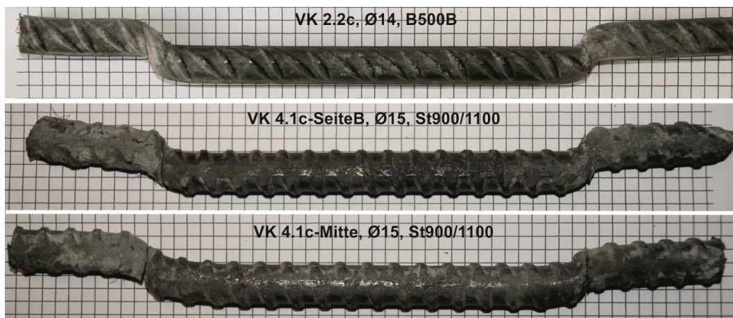
Bild 5.46: Bruchbilder von Bewehrungsstäben der Serie 2 aus normalfestem Stahl und der Serie 4 aus hochfestem Stahl
