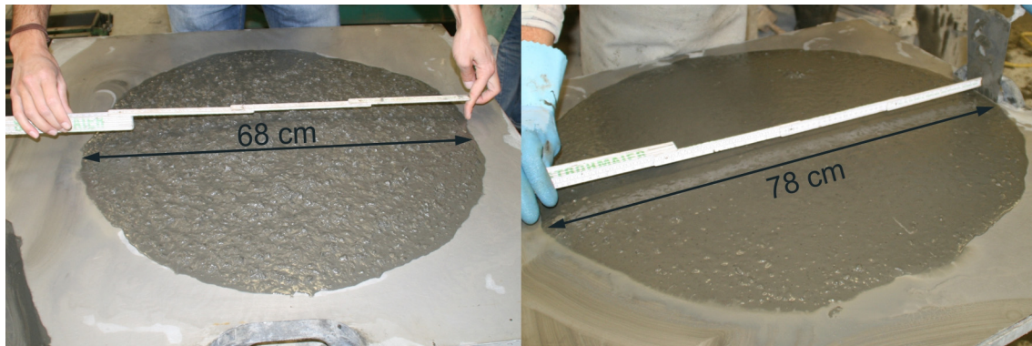
Bild 2.2: Fließmaß der UHPC-Mischung B5Q mit 2,5 Vol.-% Fasern (links) und ohne Fasern (rechts)
