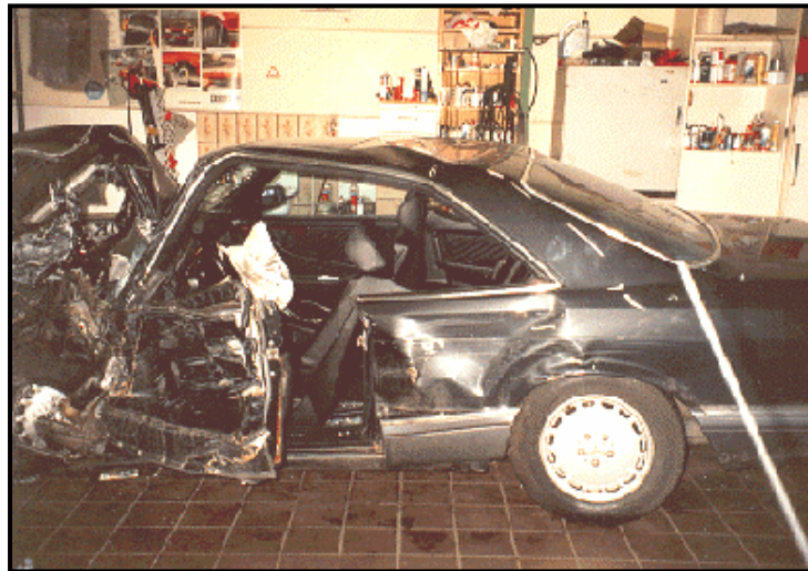
Schwere Frontalkollision mit Deformation der Fahrgastzelle
