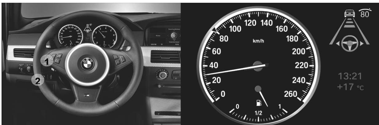
Bild 3.1: Querführungstaste (1) und Lenkstockhebel (2), Anzeigen bei aktiver Querführung
