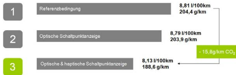
Abbildung 2: Mittlerer Kraftstoffverbrauch in Abhängigkeit der drei Versuchsbedingungen
