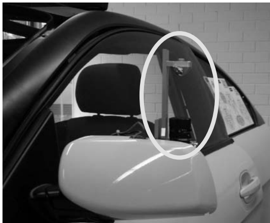
Abbildung 3. Prototypisch in den Außenspiegel integriertes Kamerasystem.
