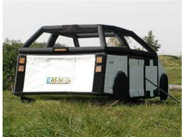
Abbildung 2: ASSESSOR Zielobjekt (links: nur Heckteil, rechts: vollständig) – ergänzend zur hier dargestellten Version können Rückleuchten, Reflektoren etc. montiert werden.
