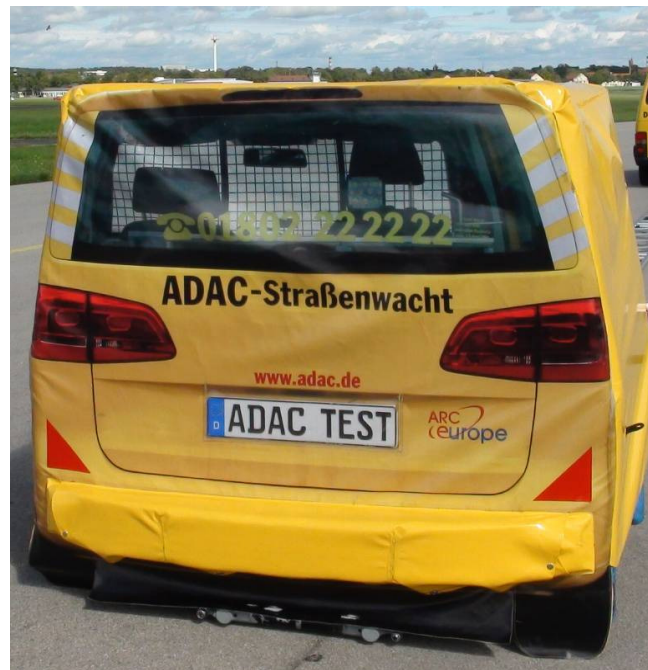
Abbildung 3: Zielobjekt “ADAC-Target” mit ADAC-Bewegungssystem (dargestellt ist Version 2, Version 3 unterscheidet sich im Wesentlichen durch eine geänderte und neutrale Bedruckung, Bildquelle: ADAC)
