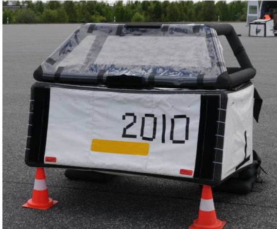
Abbildung 2: ASSESSOR Zielobjekt (links: nur Heckteil, rechts: vollständig) – ergänzend zur hier dargestellten Version können Rückleuchten, Reflektoren etc. montiert werden.
