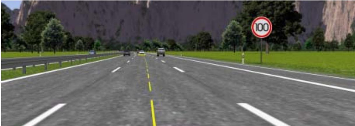
*Abbildung 3: Fehlfunktion Geschwindigkeitswechsel aus Fahrersicht mit kontaktanaloger Anzeige. Das Verkehrszeichen wurde nicht erkannt und ist dementsprechend nicht mit einem Rahmen markiert.*
