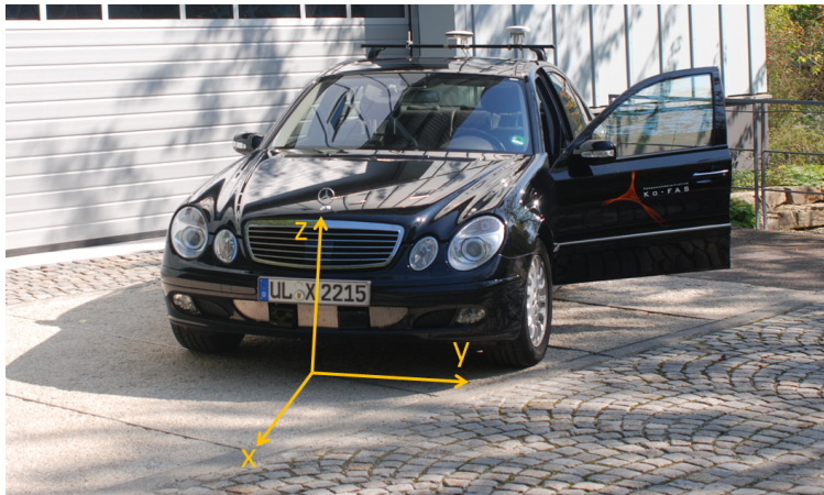
Abbildung: Ko-PER-Frame: Orientierung nach DIN 70.000, Ursprung entspricht der Projektion des Mittelpunkts der vorderen Stoßstange auf die Fahrbahn
