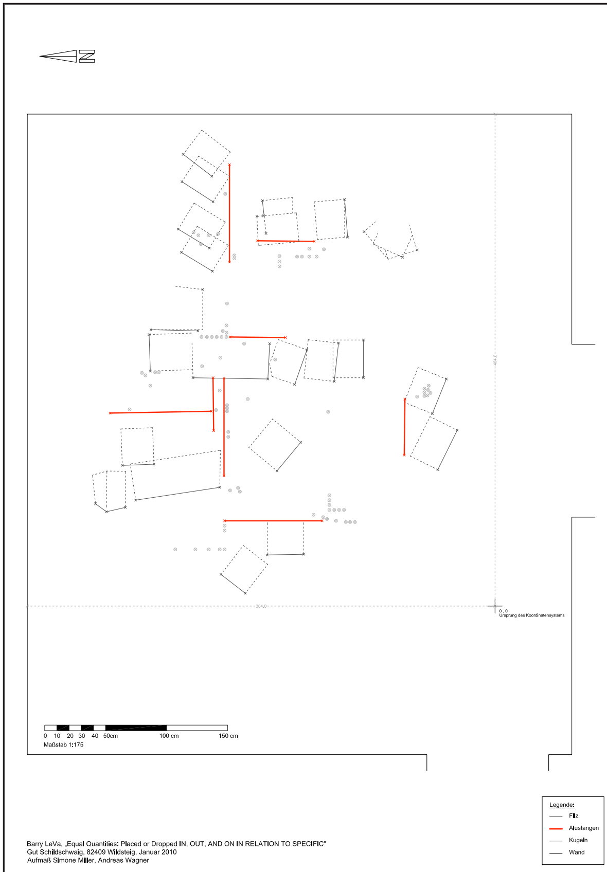
Abstrahierte CAD- Zeichnung der Skulptur aus dem Jahr 2003 mit hinterlegten Koordinaten zum Abstecken mit einem Robottachymeter und geeigneter Software (z. B. Tachy CAD); eingemessene Punkte sind mit einem Kreuz markiert; die Filzschnipsel sind in dieser Zeichnung nicht berücksichtigt.
