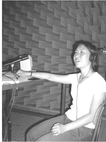
Abb. 2.4: Probandin im reflexionsarmen Raum bei der Aufnahme emotionaler Sprachsamples
