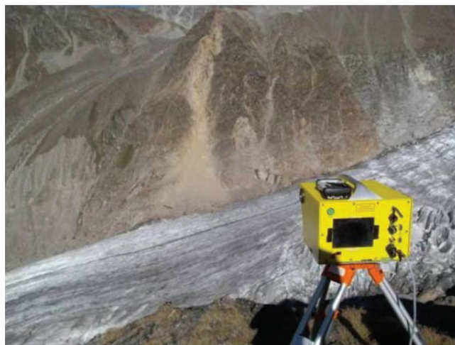
Abb. 3: Terrestrisches Laserscanning eines permanent aktiven instabilen Felsbereichs oberhalb des Gepatschferners.
