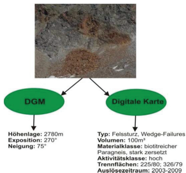
Abb. 6: Geotechnische Kennzeichen einer Massenbewegung aus der Geodatenbank (Beispiel). Fig. 6: Geotechnical properties of a mass movement, stored in the geodatabase (example).
