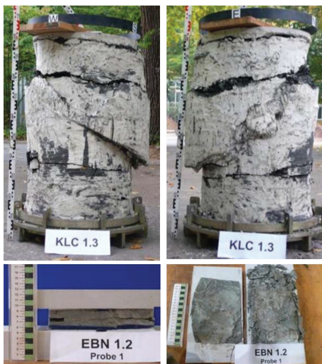
Abb. 7: Abgeschnittene Großtriaxialprobe und Rahmenscherversuch nach Versuch des Lias \delta aus dem Voreinschnitt Nord Tunnel Eierberge (Fotos: KIT/DB AG)
