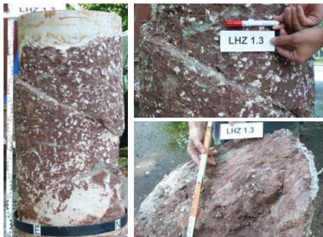
Abb. 6: Abgeschnittene Großtriaxialprobe des Feuerletten nach Versuch aus dem Voreinschnitt Nord Tunnel Lichtenholz (Fotos: KIT/DB AG)
