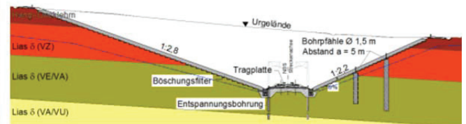
Abb. 11: Voreinschnitt Nord Tunnel Eierberge
