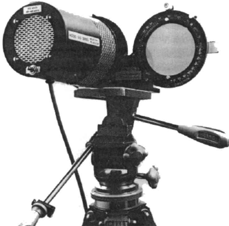
**Abb. 2.4.1.4 Reflexionspolariscope; Modell 031, MEASUREMENTS GROUP MESSTECHNIK GMBH, Lochham /München**
