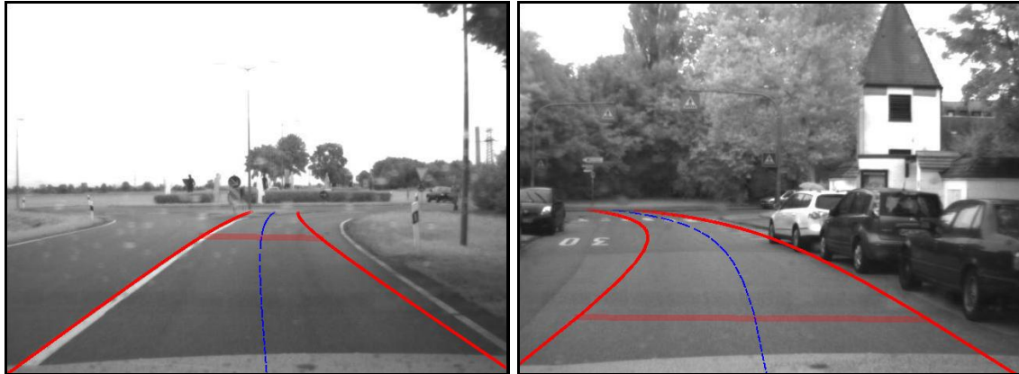
Abb. 5: Sicherheitskonzept „freier Korridor“: Fahrschlauch bei unterschiedlichen Kurvenradien und Bremswegen.
