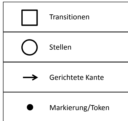
Abbildung 2-10: Elemente von Petri-Netzen
