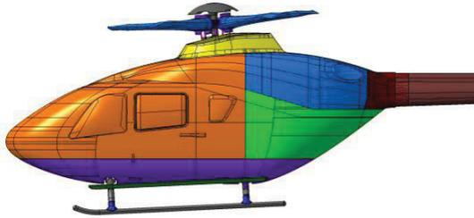
BILD 2. CAD-Seitenansicht des Windkanalmodells.
