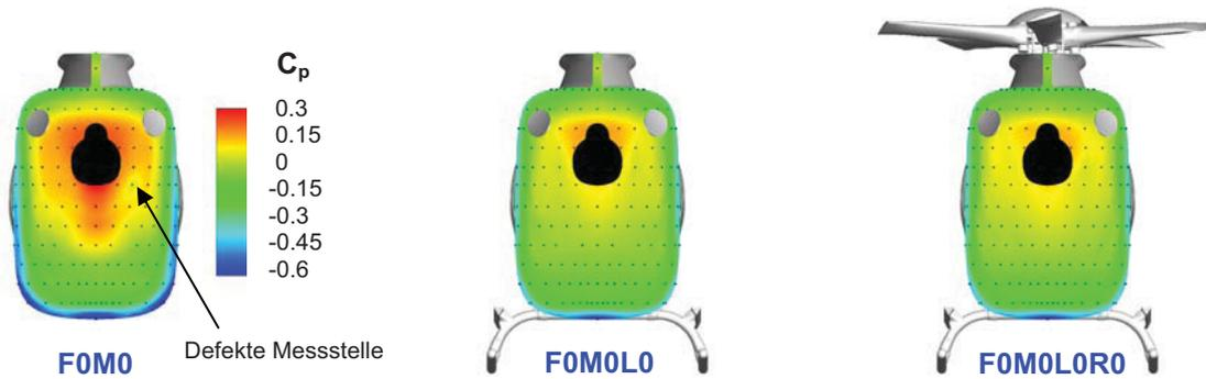
BILD 19. F0M0, F0M0L0 und F0M0L0R0: stationäre Oberflächendruckverteilung,  $C_p$  bei  $\alpha = 0^\circ$  und  $\beta = 0^\circ$ .
