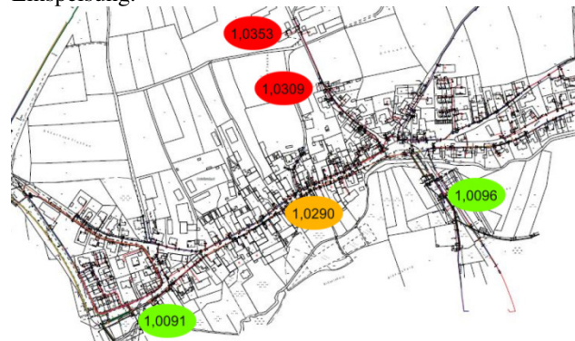
Bild 7: Spannungsverhältnisse zum Zeitpunkt maximaler Rückspeisung in der Winterzeit
