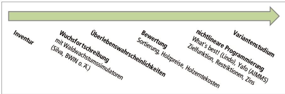
Abb. 1: Notwendige Daten und Verarbeitungsschritte zum Aufsetzen eines Betriebsoptimierers
