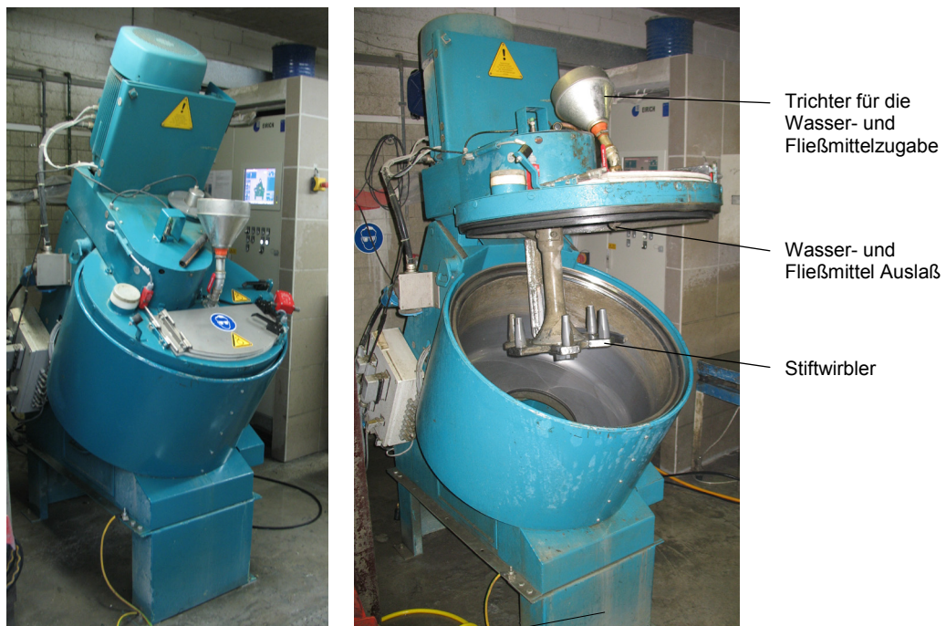
Abbildung 5.6: 75 l - Intensivmischer mit Stiftwirbler und Steuereinheit (Eirich, Typ R08W)
