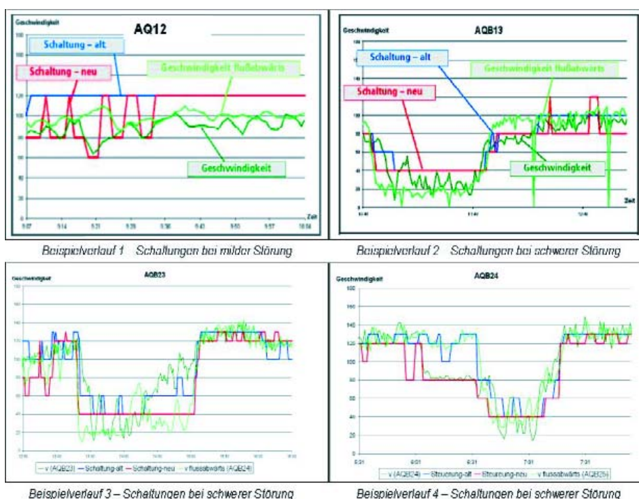
Bild 9: Geschwindigkeitsverläufe und Schaltfolgen; die Anzeige „Stau“ wird als 40 km/h, „keine Beschränkung“ als 130 km/h dargestellt
