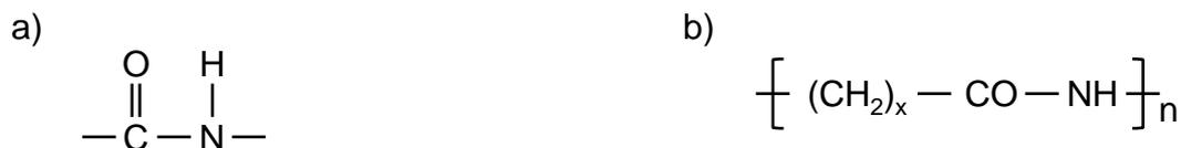
Abbildung 2.8: Strukturformel der Amidbindung (a) und eines aliphatischen Polyamids (b); mit Wasserstoff (H), Kohlenstoff (C), Sauerstoff (O), Stickstoff (N) und Polymerisationsgrad (n). Je nach Anzahl x der CH<sub>2</sub>-Gruppen ergeben sich unterschiedliche Polyamide.
