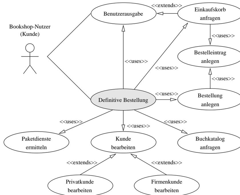
Abbildung 6.9: Nutzungsfalldiagramm: Bestellung der im Einkaufskorb liegenden Bücher
