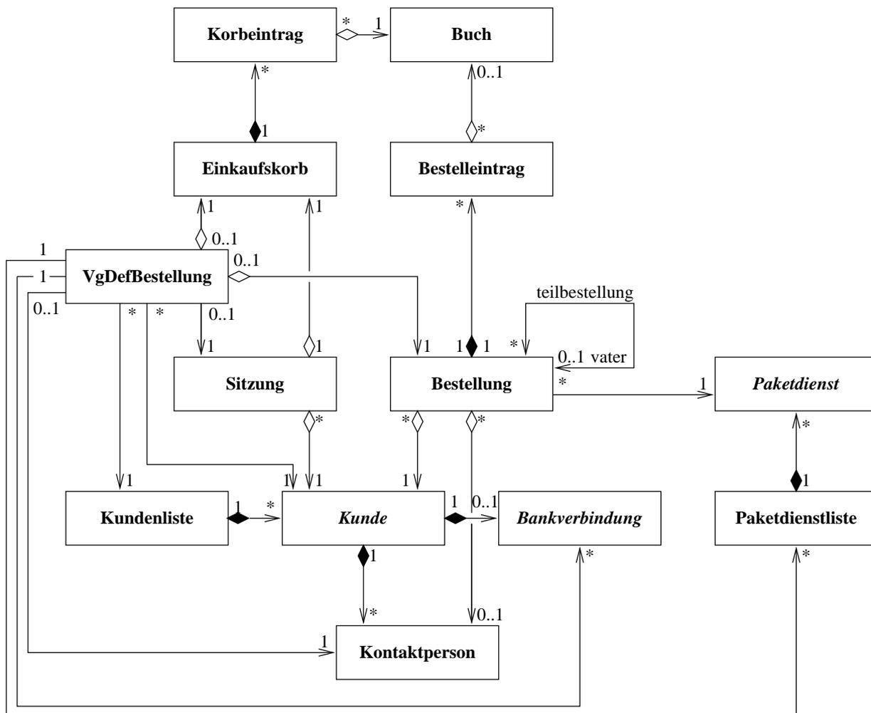
Abbildung 8.4: Klassendiagramm mit gerichteten Assoziationen, Aggregationen und Kompositionen
