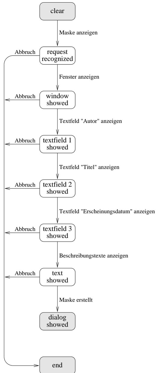
Abbildung 7.4: Erweiterte Dialoganzeige im Statechart zur zusammengesetzten Suche
