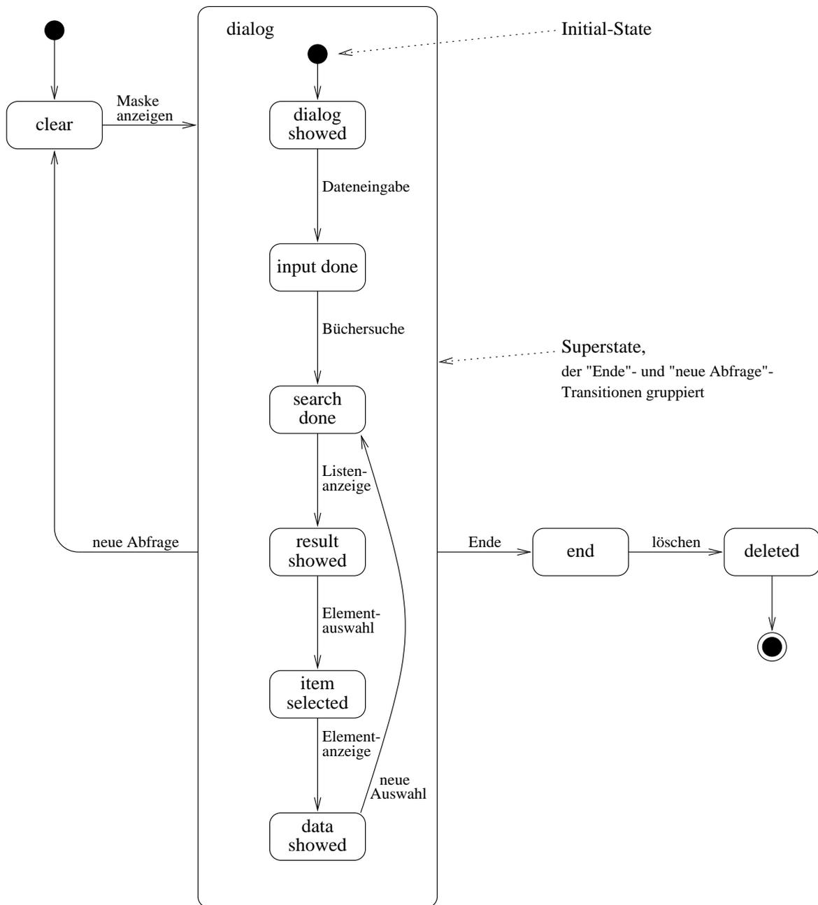
Abbildung 7.3: Statechart zur Büchersuche mit übergeordnetem Zustand
