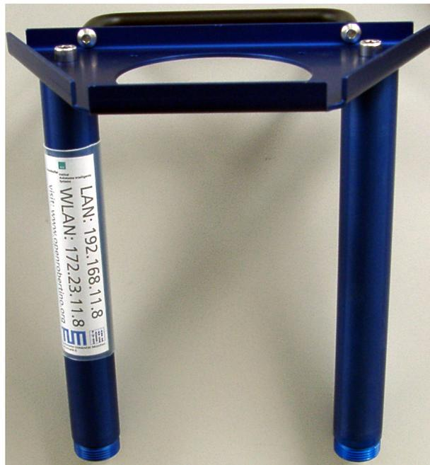
**Abbildung 2.4:** Die Kamerahalterung zur Aufnahme eines AISVision Systems.
