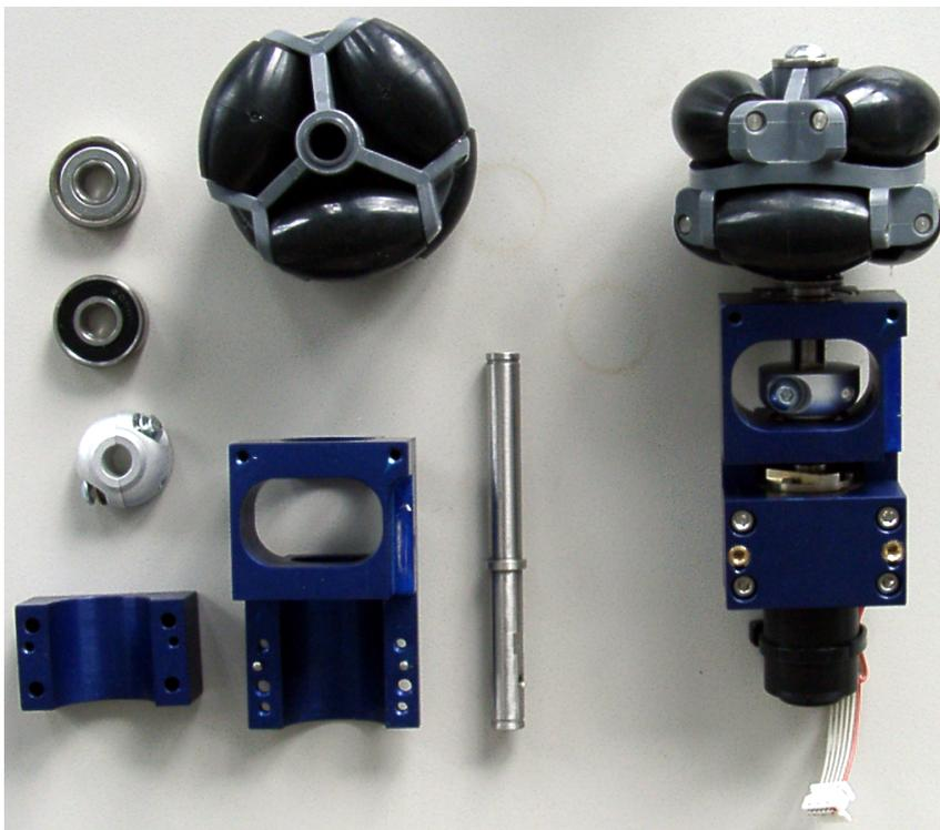
**Abbildung 2.2:** Die Antriebsgruppe montiert und in Einzelteilen.
