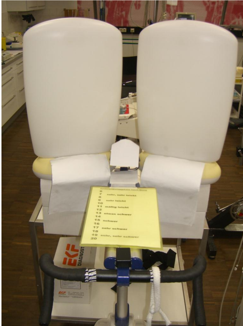
Abbildung 3.6: Ansicht aus der Fahrerperspektive bei ausgeschalteten Lampen. Die Trittfrequenzanzeige sowie die Anzeige und Einstellknöpfe der Lampen sind abgedeckt. Direkt vor dem Fahrer wurde die Borgskala befestigt.
