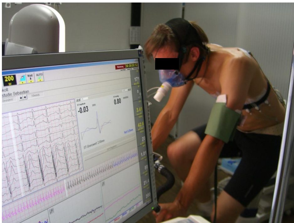
Abbildung 3.5: Ansicht von der Gegenseite mit dem vom Probanden weggedreht und somit für ihn nicht einseharen Monitor der Spirometrie- und EKG-Einheit.
