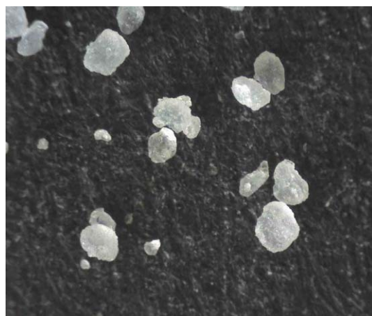
Abbildung 6.41: Zitronensäure mit 5 % Rizinusfett gecoatet, 60-fache Vergrößerung
