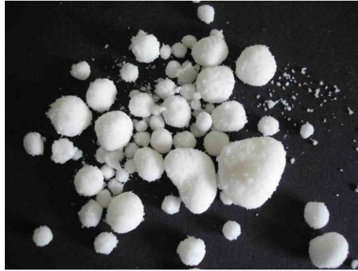
Abbildung 6.35: Durch den Luftstrahlsieb entstandene Agglomerate der Partikel mit 15 % niederschmelzendem Palmfett
