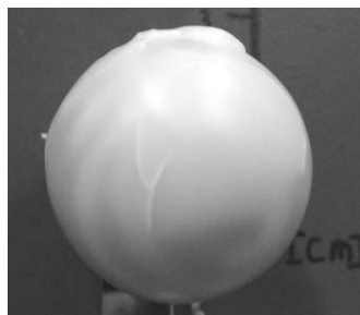
Abbildung 8.4: Aushärteverhalten von Coating-Materialien an einer Kunststoff-Modellkugel (d = 3 cm)
