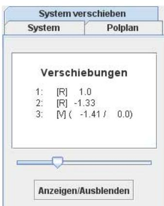
Hier kann man die Verschiebungsfigur des Systems anzeigen und ausblenden lassen. Zusätzlich wird die Relativbewegung jeder Scheibe angezeigt. Dabei steht [R] für Rotation und [V] für Verschiebung.
