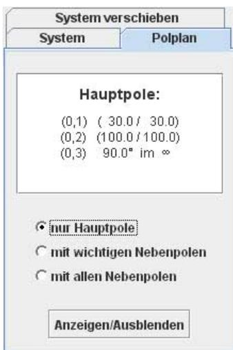
Über den Button kann der Polplan des Systems angezeigt und ausgeblendet werden. Dabei werden von allen Polen die Koordinaten oder wenn sie im Unendlichen liegen der Winkel zur x-Achse angezeigt.
