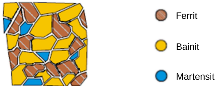
Bild 2.9: Gefügezusammensetzung von Komplexphasenstählen [Gro07]
