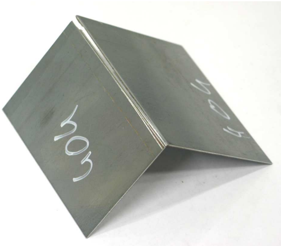
Bild 11.3: HC 500 X-IP: Unvollständige Trennung der Prüfplatine aufgrund starker Aufweitung des Schneidspalts, u_{rel} > 10\%
