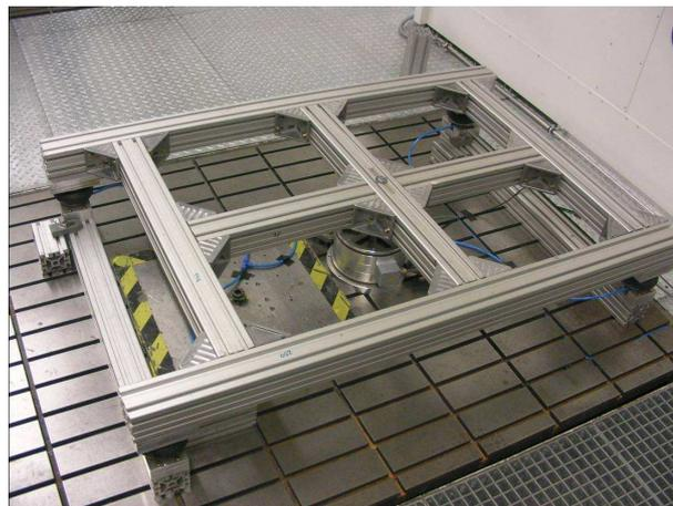
**Bild 4.2:** Komponentenshaker EMAC<sup>2</sup>-6 mit Gestell
