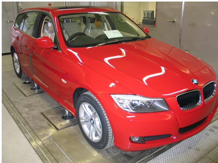
**Bild 6.3:** Ein Fahrzeug mit angedockten Shakerstangen in der Klimakammer. Im Hintergrund der Bildschirm des Bedien-PCs
