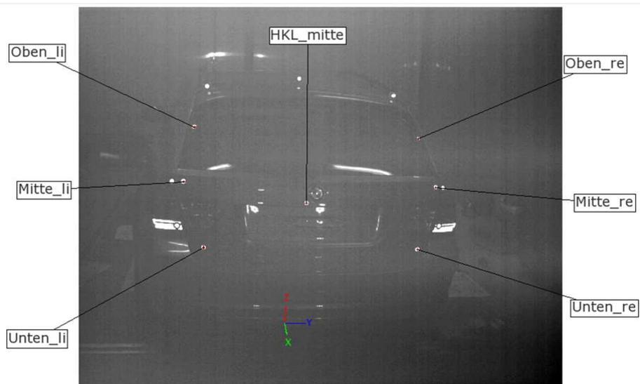
**Bild A.18:** Photometrie-Messpunkte im Heckbereich
