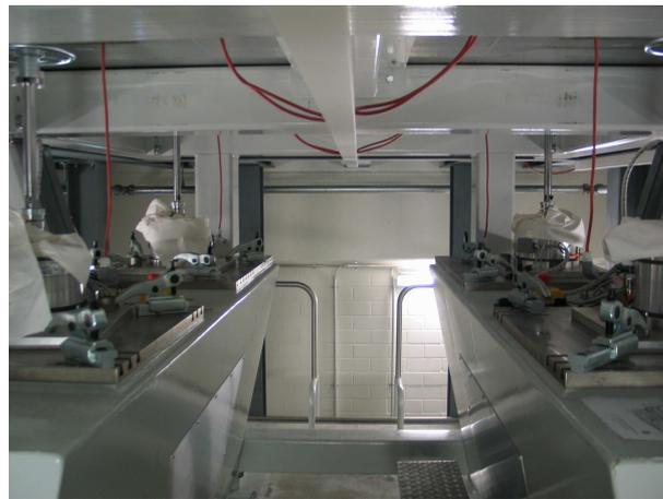
**Bild A.3:** Unterbau der Shakeranlage mit den verschiebbaren Shakern, Spannpratzen und nach oben führenden Andockstangen
