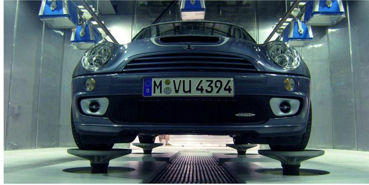
**Bild 1.3:** CREST-Anlage mit Hydropulser, Klimakammer sowie Scheinwerfern zur Sonnensimulation
