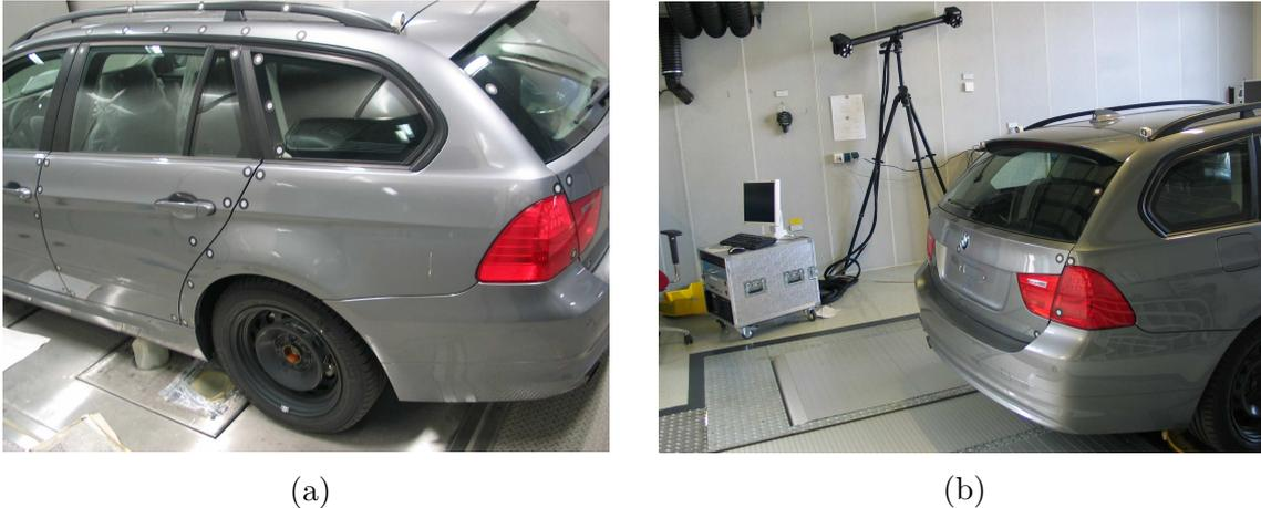
**Bild 7.3:** Photometrische Messungen der Karosserieverwindung auf Shakeranlage (a) und Hydropulser (b). In (a) sind Messpunkte im Türbereich zu erkennen, in (b) Punkte im Heckbereich und im Bildhintergrund die optische Messeinheit
