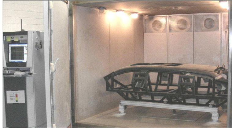
**Bild 1.1:** Komponentenshaker mit Prüfling in einer Klimakammer. Der Shaker befindet sich unter der Kammer in einer Grube
