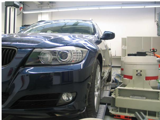
**Bild 1.4:** DKA an den Wagenheberaufnahmen mit elektrodynamischen Shakern
