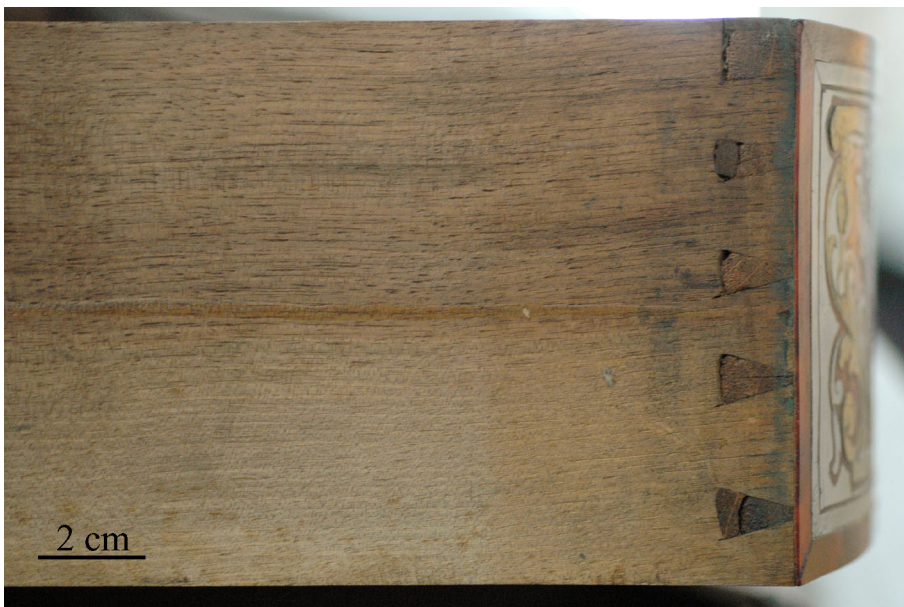
▫ 162 R 3363, vordere Zinkenverbindung der Schubkästen.
