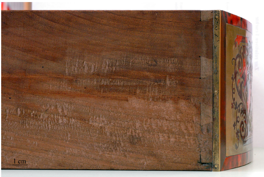
▫ 80 R 3893, Schubkasten, vordere Zinken- verbindung. Zu erkennen ist zudem die Messingleiste, die die Marketerie schützt.
