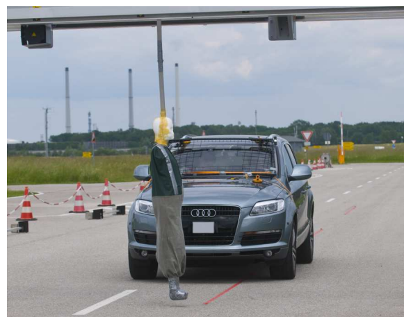
Abbildung 4-19: Fußgängerschutzanlage im Testbetrieb [AUDI 2010]
