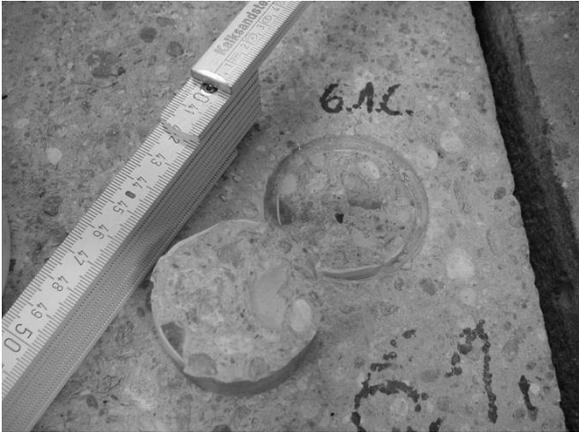
**Bild 3.3:** Bruchbild bei der Ermittlung der Oberflächenzugfestigkeit
