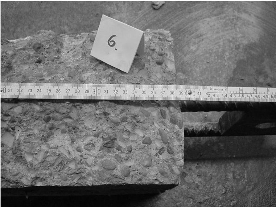
**Bild 3.13:** Ausgebrochene Betonoberfläche
