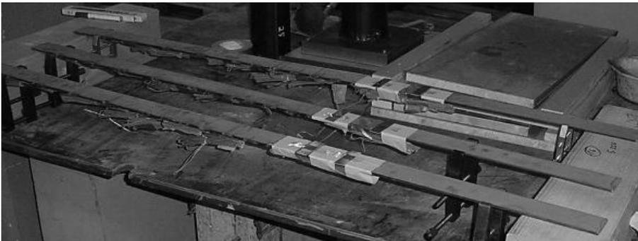
**Bild 3.5:** Vorbereitung der zu verklebenden Stahllaschen
