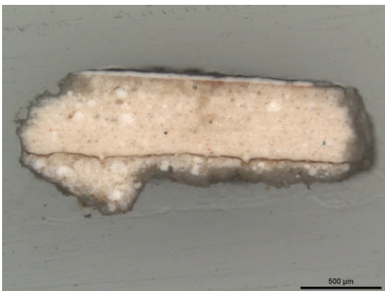
Abb. 180 P 19: Weißfassung der Balustrade VIS; 50x Vergrößerung Beigefarbene Grundierung mit weißen Körnern; bräunliche Schicht; beigefarbene Grundierung mit weißen Körnern und bräunlichen Partikeln; partiell dünne rote Schicht (vermutlich durch über den vergoldeten Bereich hinaus aufgetragenes Poliment); weiße Schicht; Schmutzschicht
