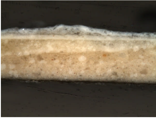
Abb. 182 P 17: Weißfassung der Fenstervertäfelung rechts auf der Empore VIS; 100x Vergrößerung Zweischichtige Beigefarbene Grundierung mit weißen und grauen Körnern und ockerfarbenen Partikel; weiße Schicht mit ockrigen und grauen Partikeln; partiell weiße Schicht mit grau-bräunlichen Einschlüssen; Schmutzschicht; weiße Schicht mit grauen Einschlüssen
