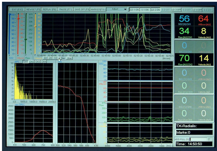
Abb. 9: Ansicht des 02C-Monitors mit Onlinepräsentation der Oxygenisierungswerte und Blutflussparameter.
