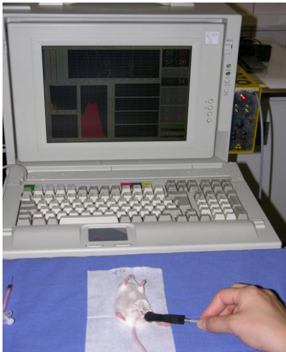
Abb. 5 Messung von Hämoglobin-Oxygenierung und mikrovaskulärem Blutfluss bei der narkotisierten Maus mittels O2C.
