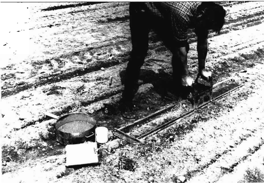
Abb. 41: Ermittlung der Korn-Tiefenablage mit dem Boden-hobel
