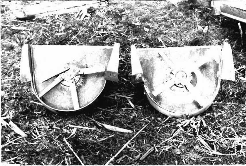
Abb. 91: Messeranordnung bei den Leistungsbedarfs-Messungen (links: gelenkige Anbringung; rechts: Anordnung in 2 übereinander liegenden Ebenen)
