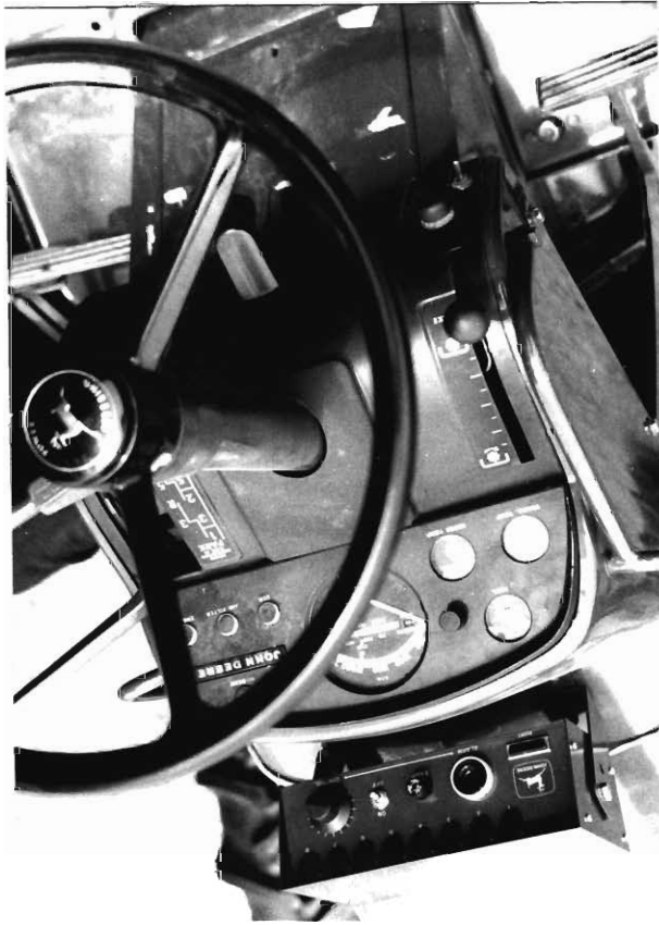
Abb. 57: Ablagekontrolle durch optische Anzeige im Blickfeld des Schlepperfahrers
