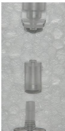
Abbildung 6-14: Anschlussstücke an die Elektrodenreservoirs für die Elektroelutionskassette
