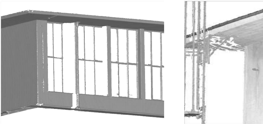
Abbildung 37: Fehlstellen im Bereich von Verschattungen
