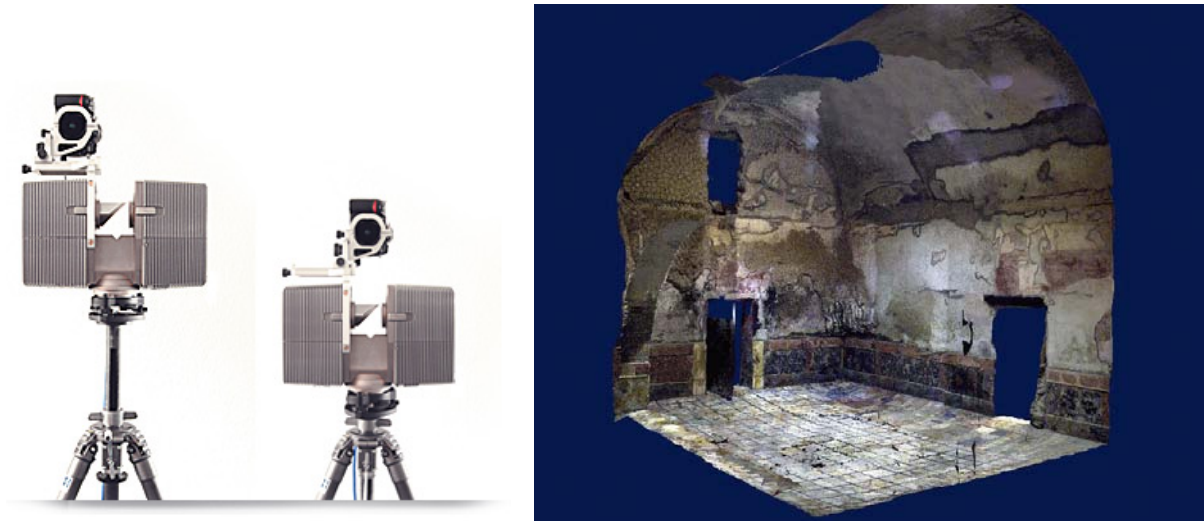
Abbildung 15: „Farb-Laserscanner“ Faro LS, links (Faro 2009) und eingefärbte Punktwolke, Herkulaneum, rechts (DeltaSphere 2008)
