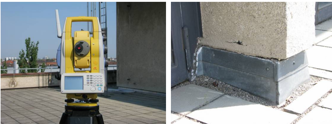
Abbildung 26: Topcon Imaging-Station IS, Fußpunkt Pfosten im Bereich der Türen
