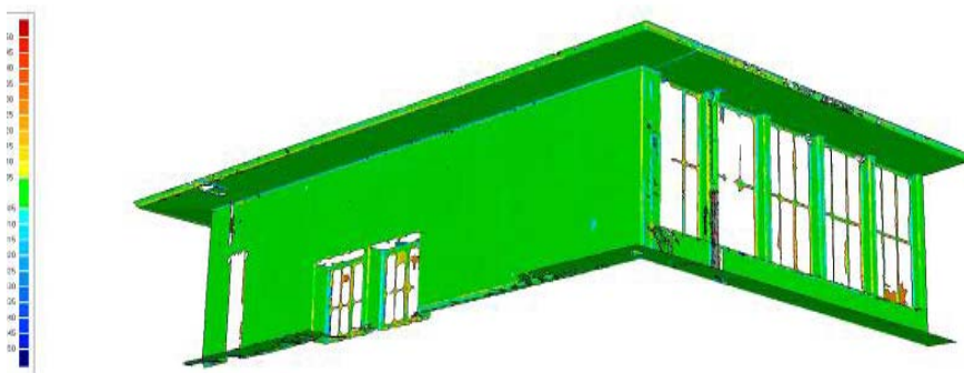
Abbildung 50: grafischer Abgleich Netzmodelle verschiedener Laserscanner
