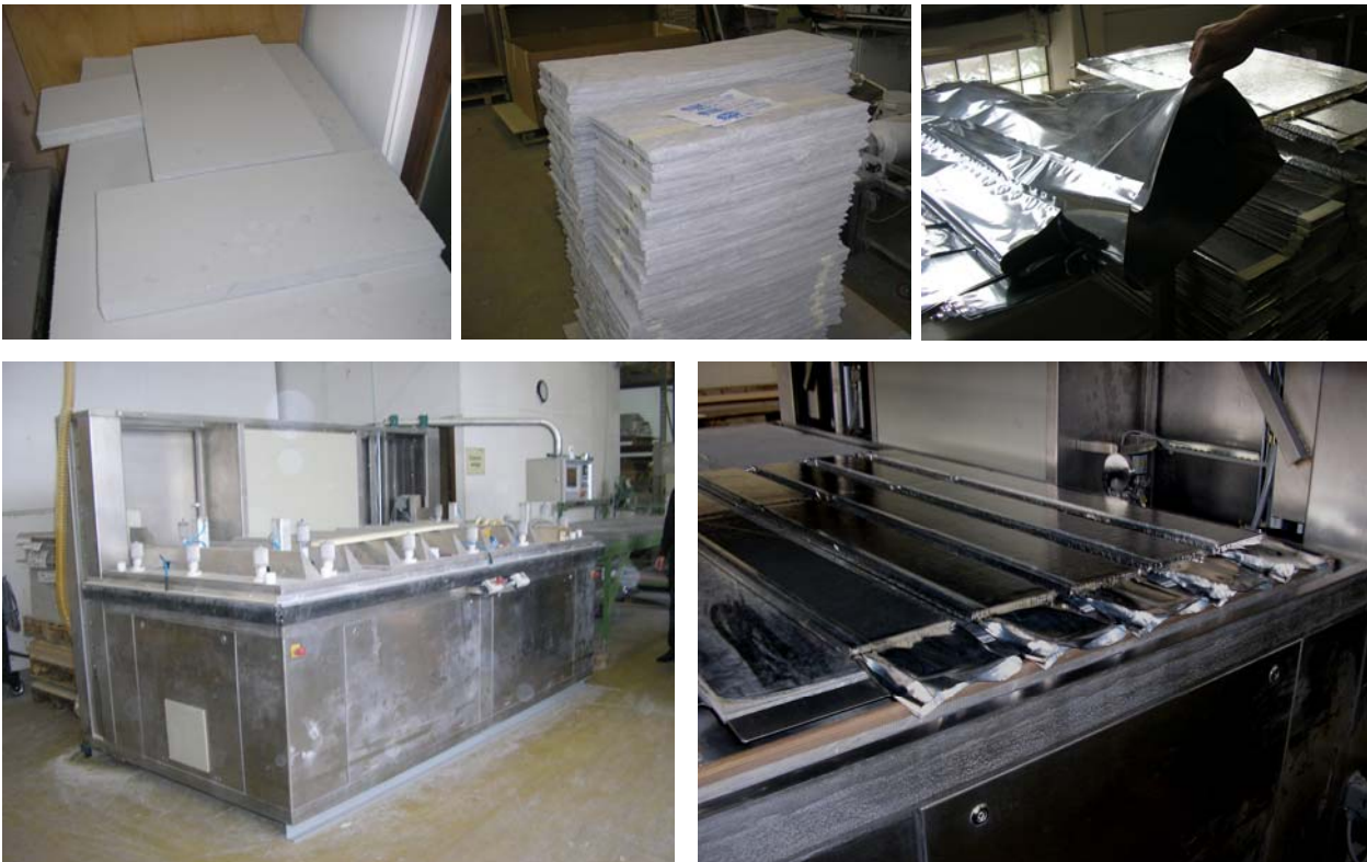
Abbildung 6: Herstellung von Vakuum-Dämmelementen bei Variotec (von links oben nach rechts unten): 1. Zugeschnittene Platten aus pyrogener Kieselsäure, 2. mit Flies ummantelte Stützkörper, 3. dreiseitig geschlossener Beutel aus Hochbarrierefolie, 4. Vakuumkammer und 5. maßgefertigte Vakuum-Dämmelemente.
