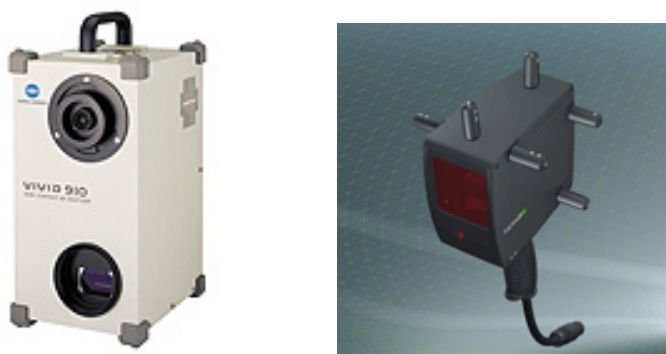
Abbildung 16: Triangulationsscanner Konica Minolta VI-910, links (Konica Minolta 2009a) und handgeführter Laserscanner Steinbichler T-Scan 2, rechts (Steinbichler 2009)
