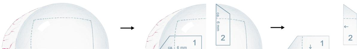
Abb. 2-7: Weiterer Zuschnitt der Hornhäute für die Lichtmikroskopie. Die blauen Pfeile markieren die jeweilige Anschnittfläche des Mikrotoms.
