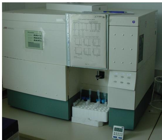
Abb. 6: Das „FACS“ Calibur TM-Durchflusszytometer
