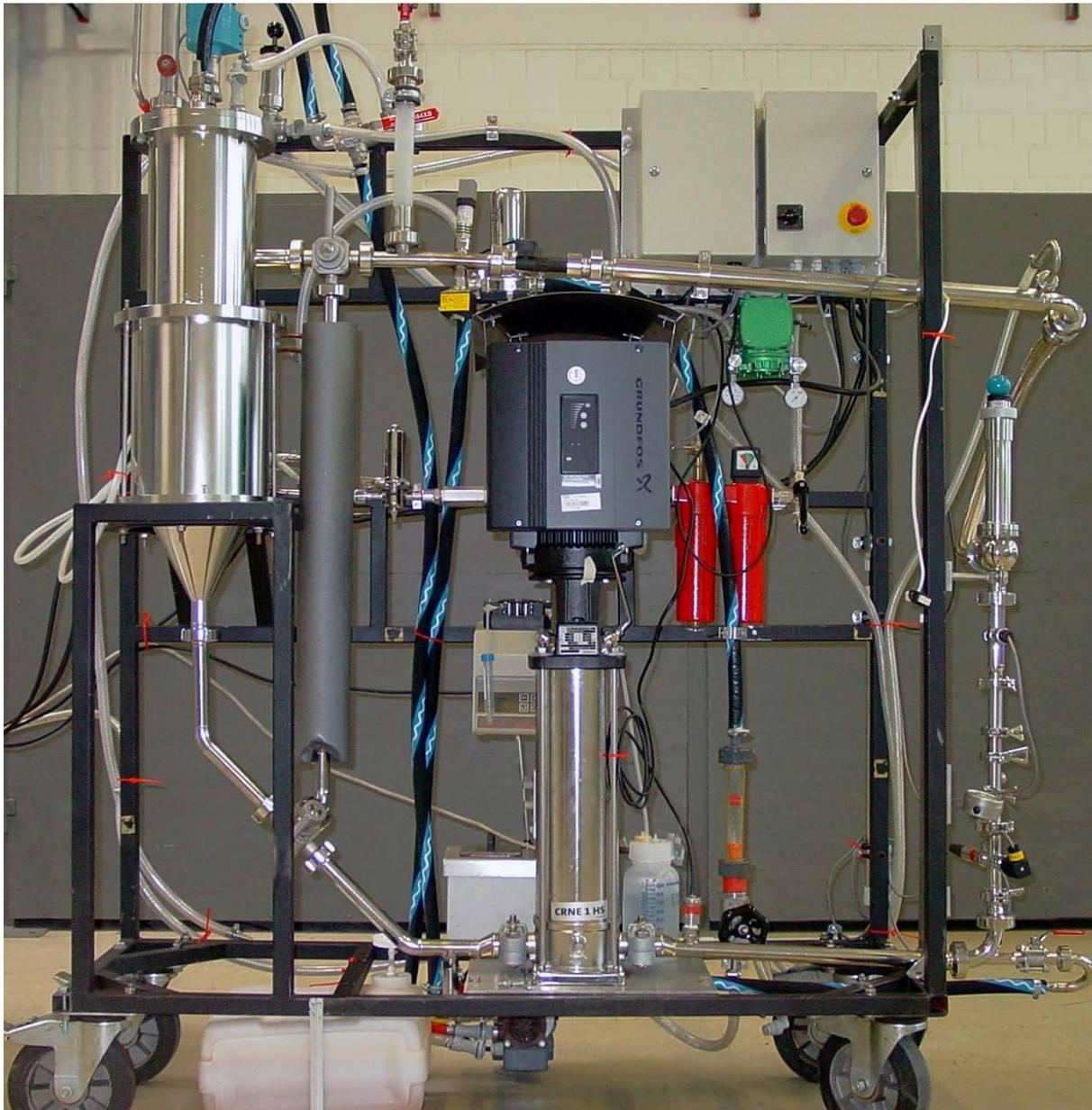
**Abbildung 4.2: Fotografie der Versuchsanlage zur Untersuchung der Kombination von hydrodynamischer Kavitation und Chlordioxid zur Desinfektion.**
