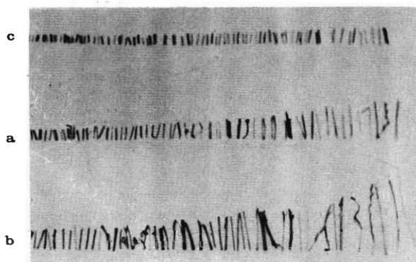
Bild 51 Einfluß der Stellung der Gegenschneide auf die Häcksellänge. Häckselprobe in der Mitte a) b) und c) geneigte Stellung um ca. 12^{\circ}
