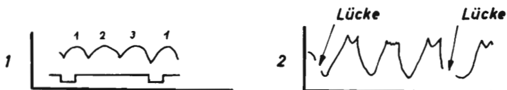
Bild 61 Beschreibung der Drehzahlbestimmung bei Verstärkung der Amplituden. Lücke zum Diagrammschrieb zeigt den Drehwinkel an.
