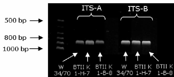
Abbildung 16: PCR-Amplifikate der ITS1-5,8S-ITS2-rDNA der Hefestämme S. pastorianus UG W 34/70, S. cerevisiae var. diastaticus BTII K 1-H-7, 1-B-8 nach den Temperaturprotokollen ITS-A (Ursprungsprotokoll) und ITS-B (optimiertes Protokoll)
