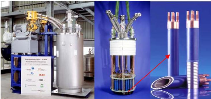
**Abbildung 4.3:** Bild des 10KV, 10MVA resistiven SSB CURL10. In der Mitte ist der Kryostateinsatz mit den BSCCO-Elementen (rechts) zu sehen (aus [103]).
