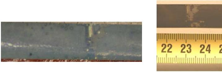
**Abbildung 4.30:** Aufnahme eines gequenchten Bereichs einer Probe ohne Randkontakt
