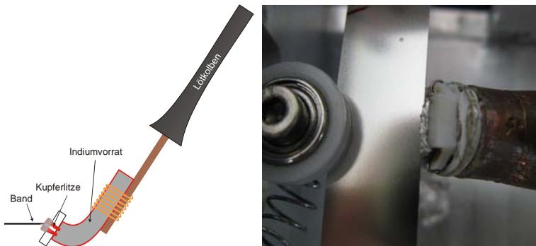
**Abbildung 4.17:** Schematischer Aufbau und Bild der verwendeten Lötvorrichtung
