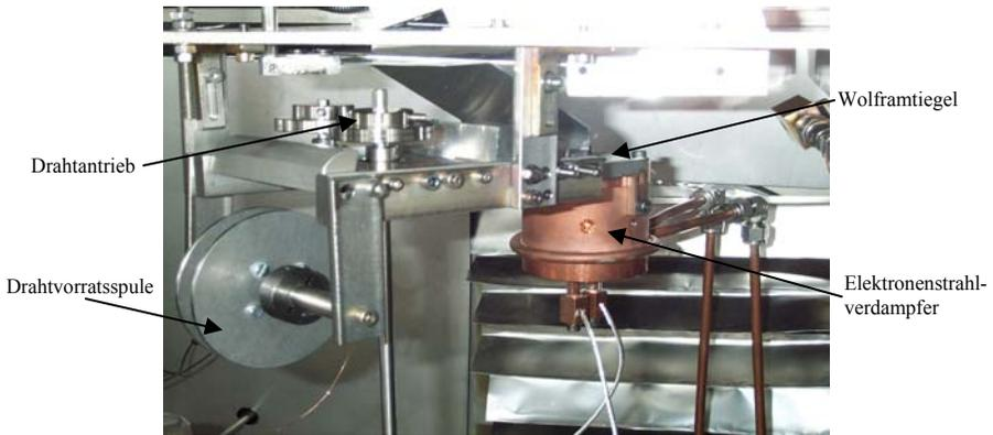
**Abbildung 3.2: Elektronenstrahlverdampfer mit Drahtnachförderung für Silberdraht**
