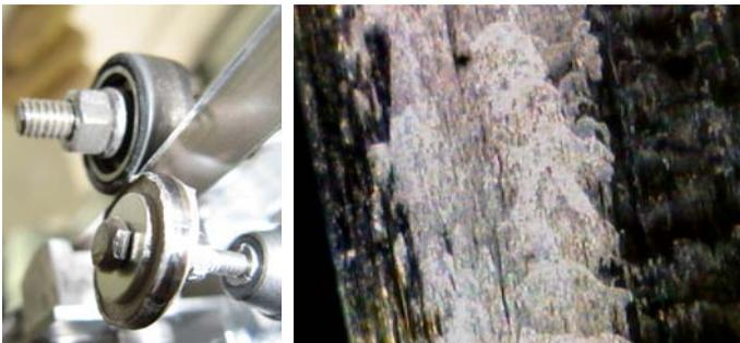
**Abbildung 4.18:** Indiumschleifrad (links) und in die Rückseite eingearbeitetes Indium (rechts)
