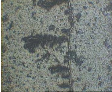
**Abbildung 4.38:** Riss im Supraleiter im Bereich ohne Randkontakt
