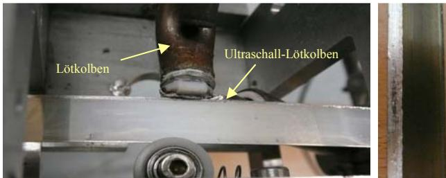
**Abbildung 4.19:** Zusätzliche Verwendung eines UltraschalllötKolbens (links) und der damit hergestellte Randkontakt (rechts)
