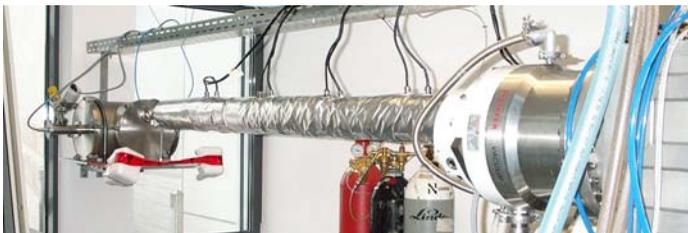
**Abbildung 3.4:** Rohrofen mit Heizmanschetten zur Beheizung des Ofens auf bis zu 650°C
