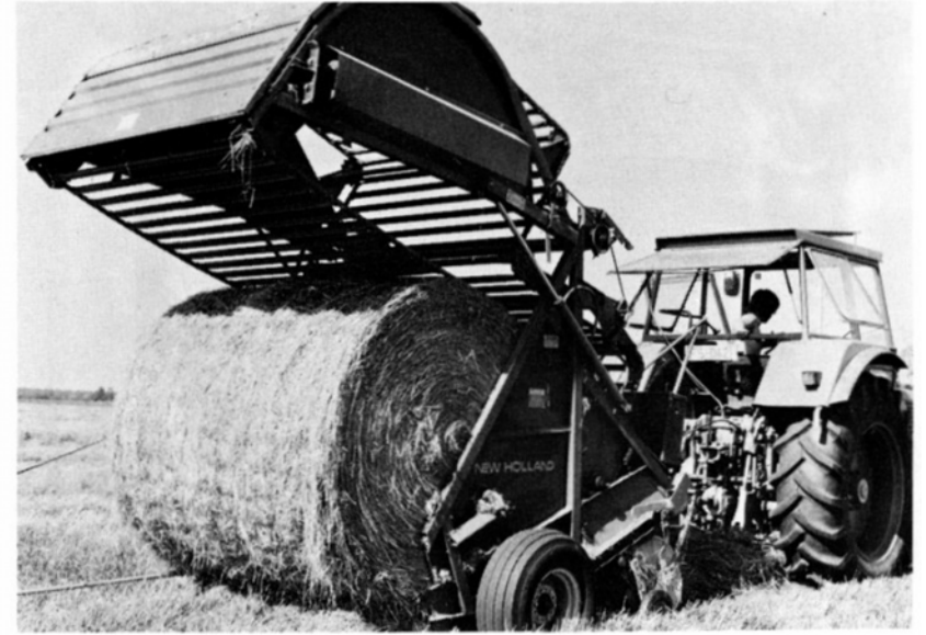
Bild 3: Rundballenpresse mit umlaufenden Ketten
