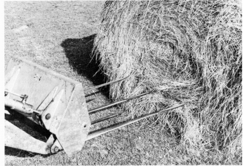
Bild 11: Hydraulisch schwenkbare Frontladergabel mit Federstahlzinken für Großballen
