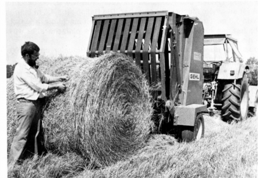
Bild 4: Rundballenpresse mit umlaufenden Bändern
