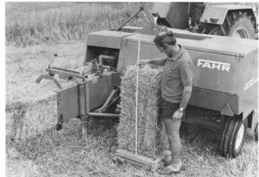
Bild 16: Höchstdruckpresse mit einem 80 cm langen und 30 kg schweren Strohballen
