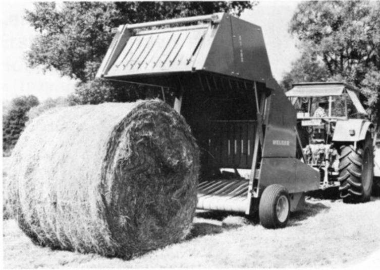
Bild 5: Rundballenpresse mit 6eckiger Preßkammer
