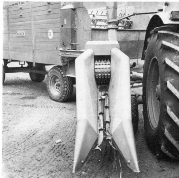
Bild 5: Maiskolbenschrothäcksler der Fa. Mengele
