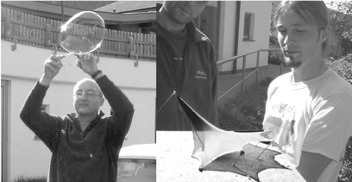
**Abbildung 3.3:** Experimentelle Formfindung mit Seifenhäuten und Strumpfmodellen.
