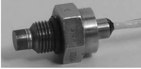
Abbildung 4.4: Sensor für die instationäre Druckmessung in der Zuleitung
