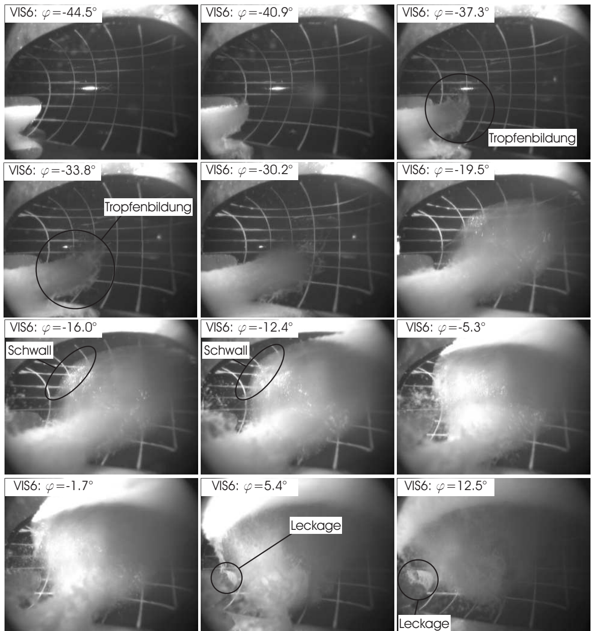
Abbildung 6.25: Visuelle Analyse der Becherströmung bei VIS6
