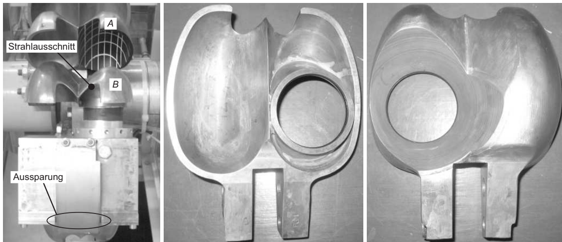
Abbildung 4.17: Links: Draufsicht auf das eingebaute Kamerasystem; Mitte und rechts: Becher B mit eingesetztem Rotgussdrehteil
