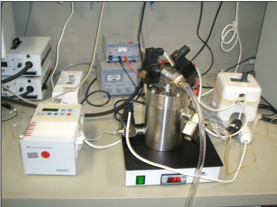
Abb. 2.9: Betriebsfertiger Bioreaktor ohne Isolierung
