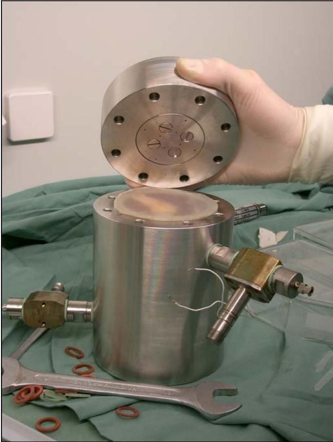
Abb. 2.8: Bestückter Bioreaktor vor dem Verschluss
