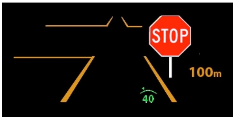
**Bild 4-9:** Stop-Schild-Assistent: Voranzeige im HUD, Stop-Schild in 100 m Entfernung
