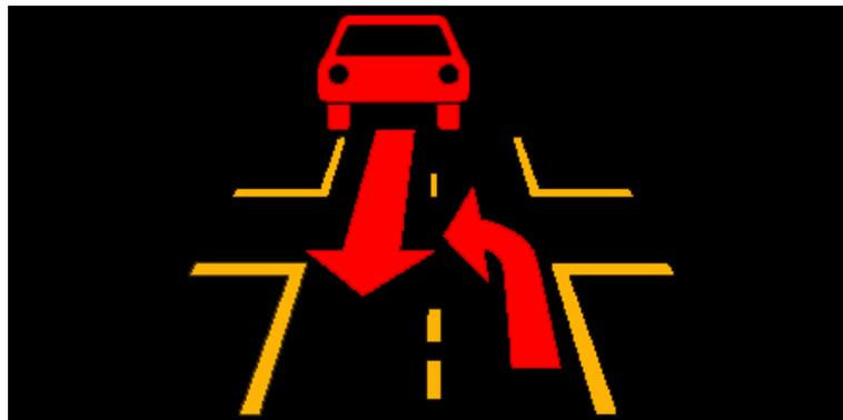
**Bild 5-29:** Warnsymbol im Head-Up-Display bei Systemeingriff
