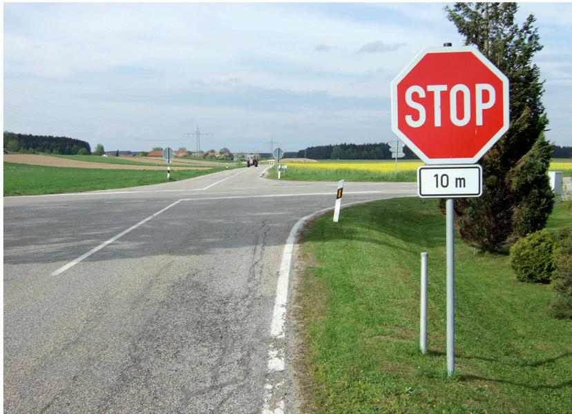
**Bild 4-13:** Stop-Schild vor der Haltelinie: Mögliche fehlerhafte Entfernungsmessung bei Videoerfassung
