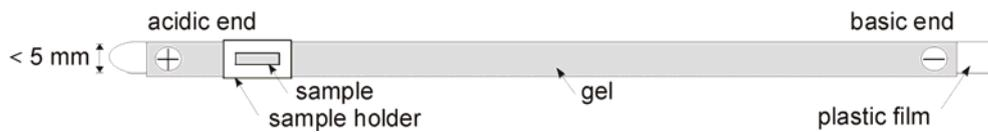
Abbildung 4-10: Positionierung des Probenhalters auf dem IPG-Streifen [34]
